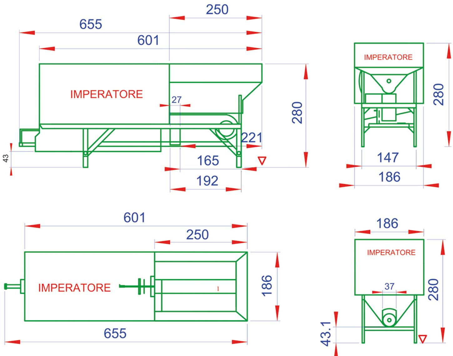
**Motore Automazione: 5,5 hp - Motore Coclea: 2 hp - Motore Alimentatore: 2 hp - Produzione Oraria: 200 q**
