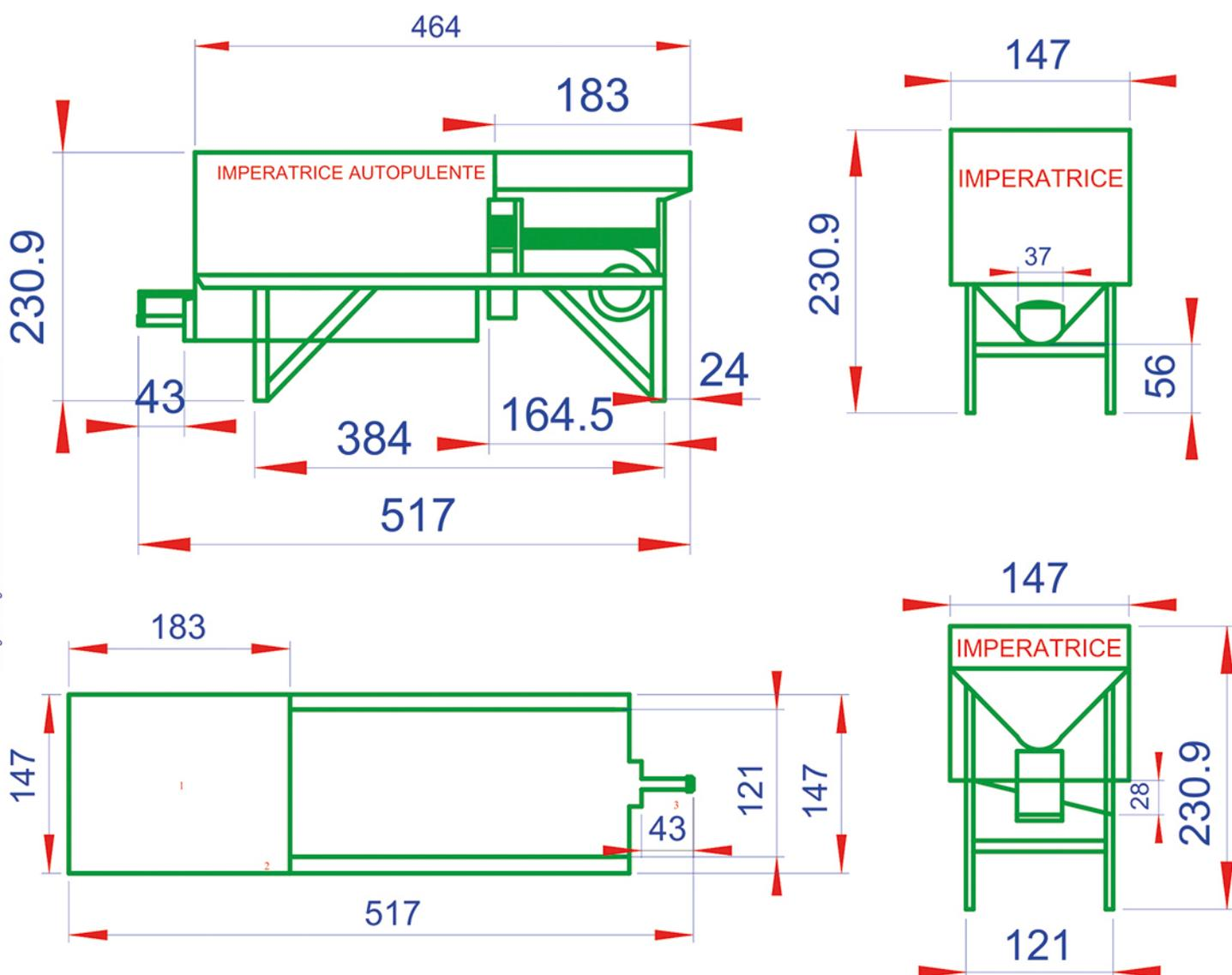
**Motore Automazione: 5,5 hp - Motore Coclea: 2 hp - Motore Alimentatore: 2 hp - Produzione Oraria: 120 q**
